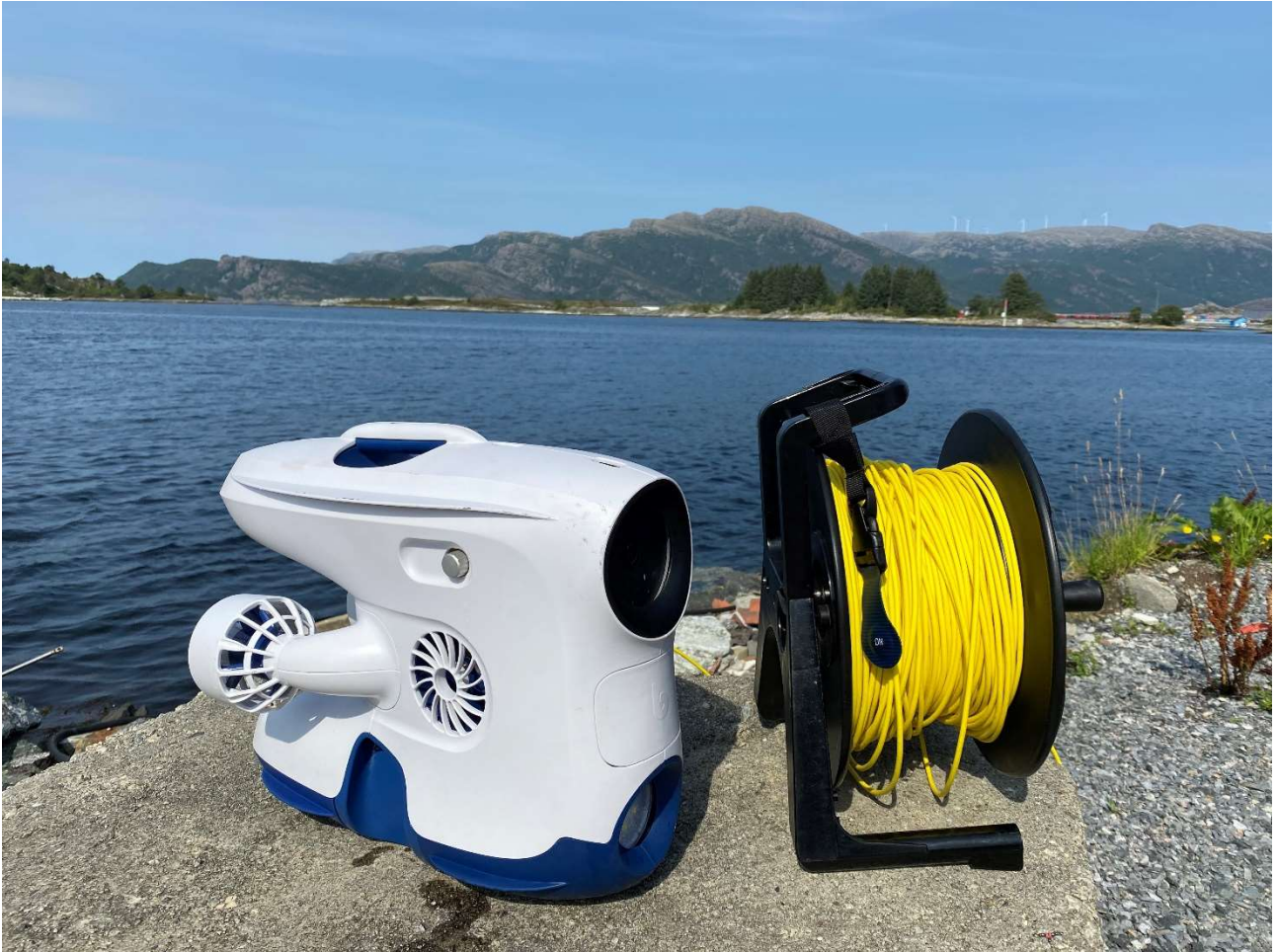
Figur 4: Undervannsdronen Blueye Pioneer som ble brukt i dette oppdraget
