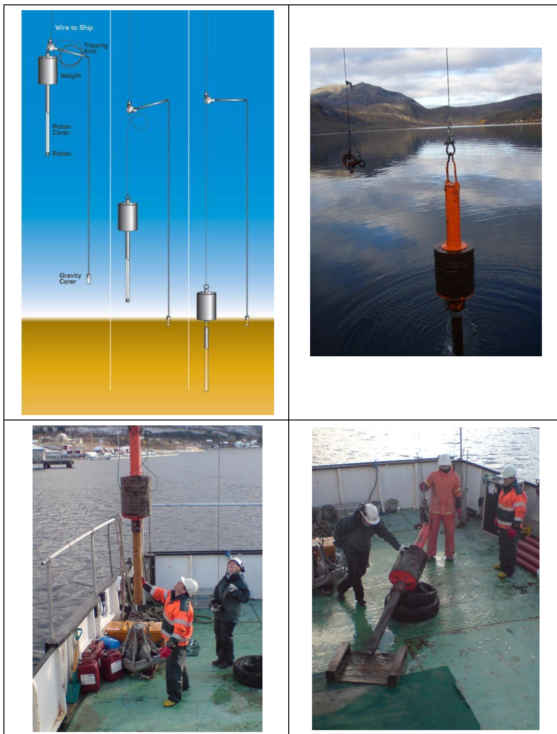
Figur 2 Prinsipskisse for prøvetaking med "pistoncorer". Multiconsults "pistoncorer" i bruk.
