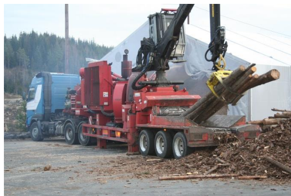
Flising ved entreprenør Holmgren. Foto: Tore Holaker.
