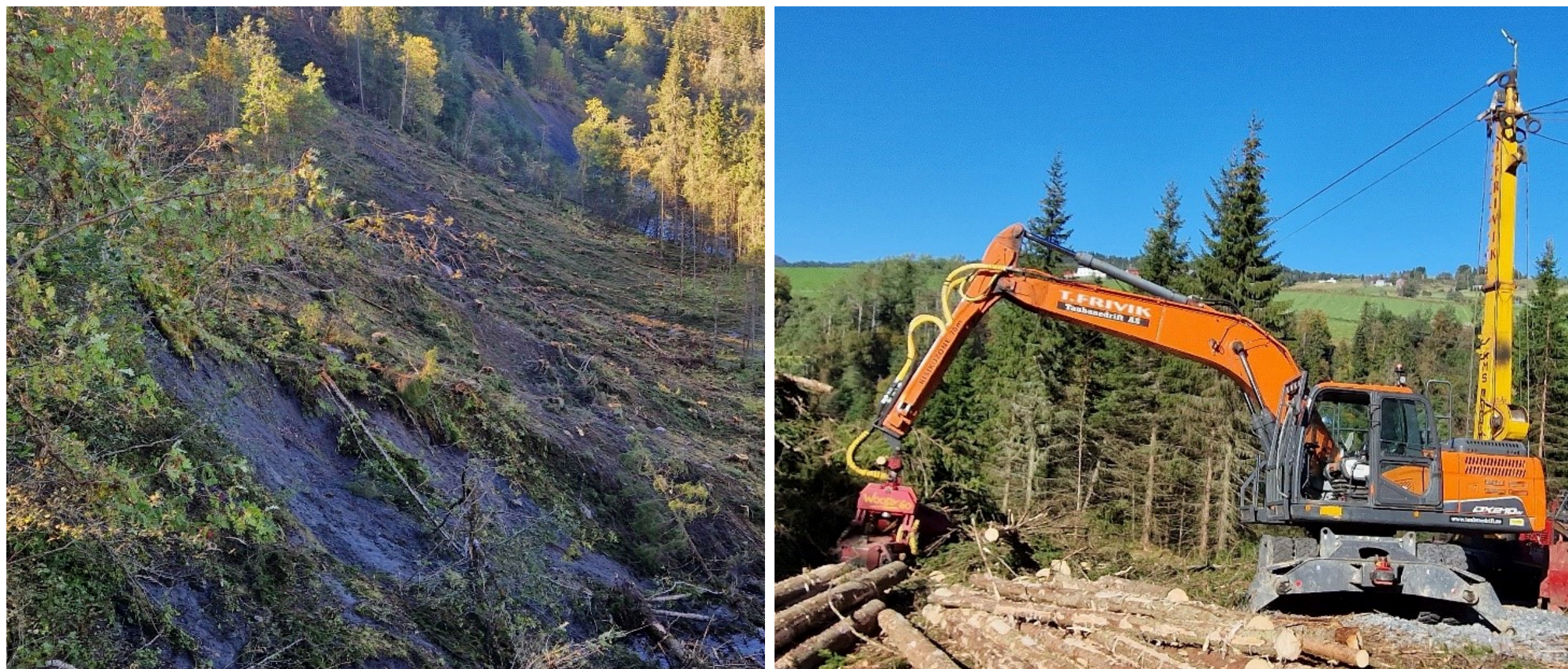
Bilde 2 og 3: Drift med taubane i rasutsatte områder gir mulighet for å ta ut tømmer uten sporsetting og økt rasfare. Her fra en drift i Gausdal 2024. Foto: Carl Olav Holen
