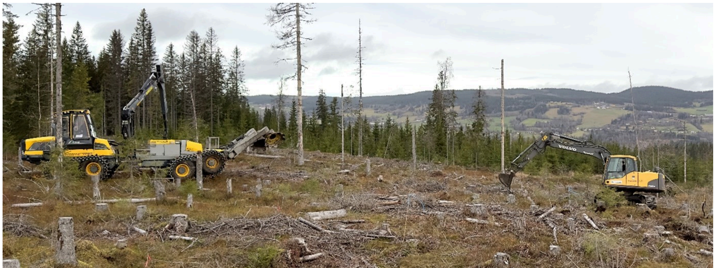
Bilde 8: Markberedning med lassbærer og gravemaskin på forsøksfeltet i Gjøvik. Foto: May-Sylvi Skinnerlien, Skogkurs
