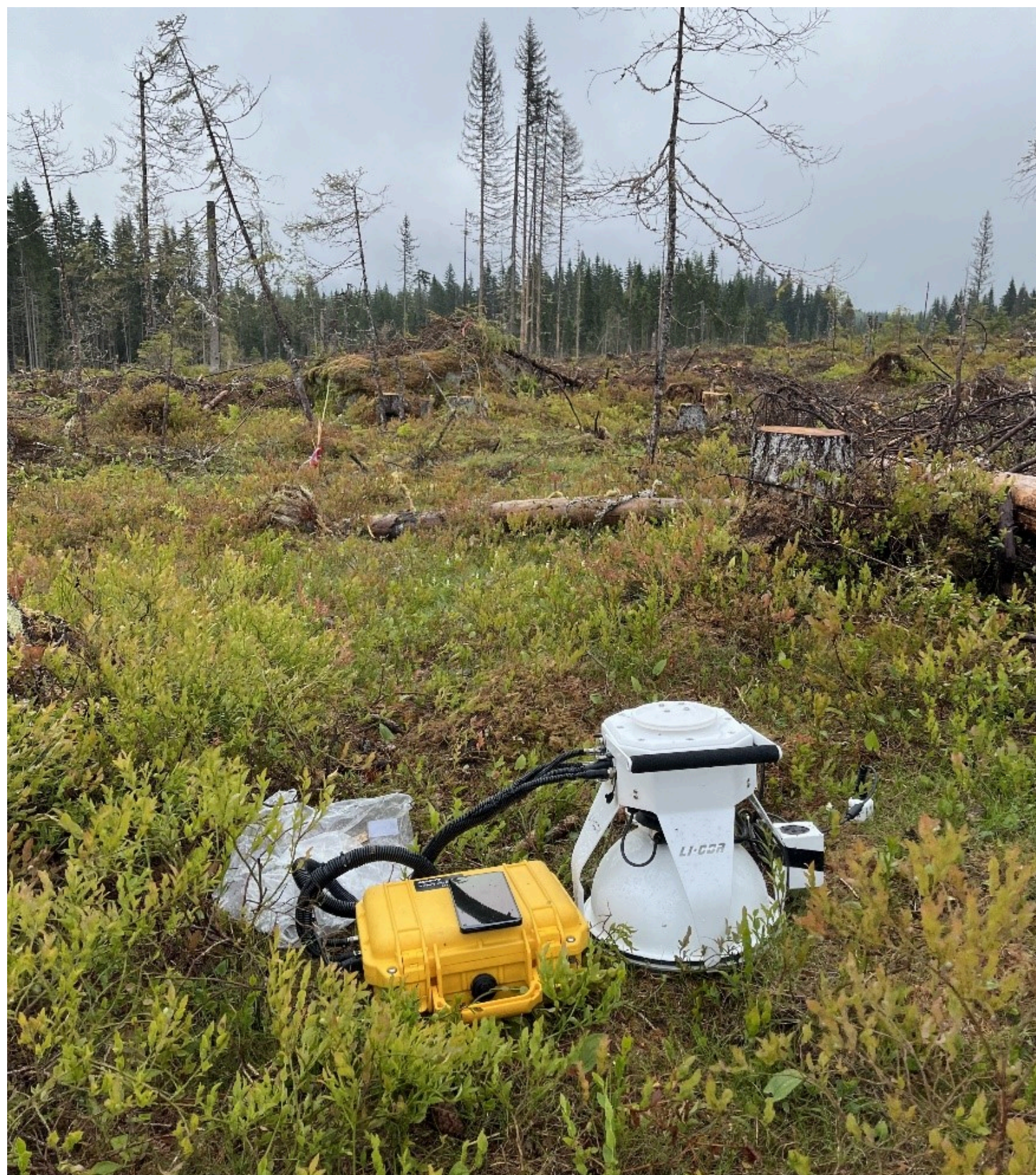
Bilde 7: Måling av jordrespirasjon på forsøksfeltet i Gjøvik. Foto: Ruben Eik Birkeland
