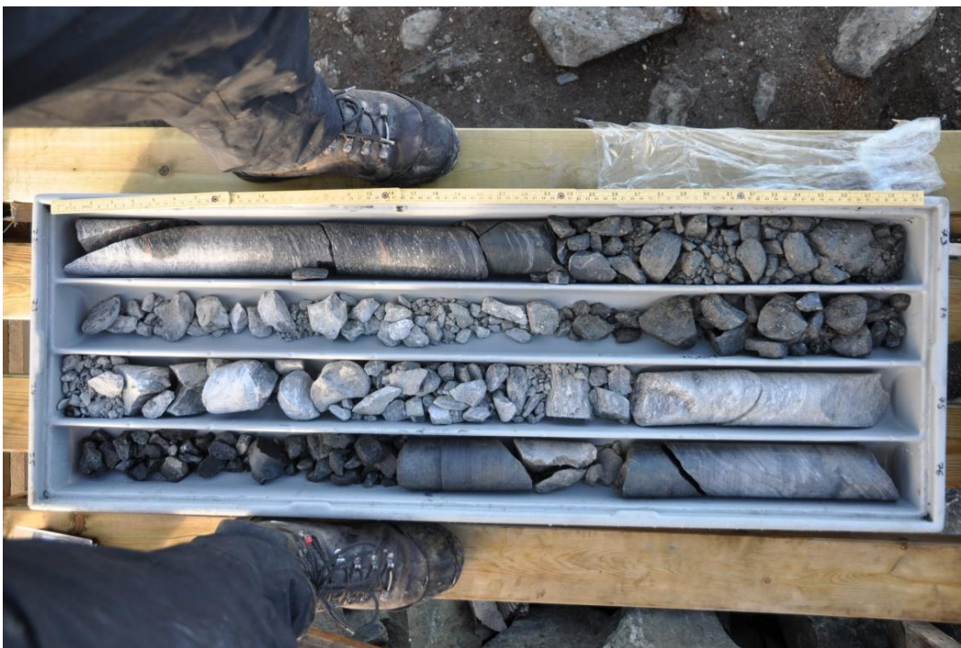
FIGUR 6. BOREKJERNAR MELLOM 72 OG 76 M DJUP SOM VISER STORE KNUSINGSSONER.
