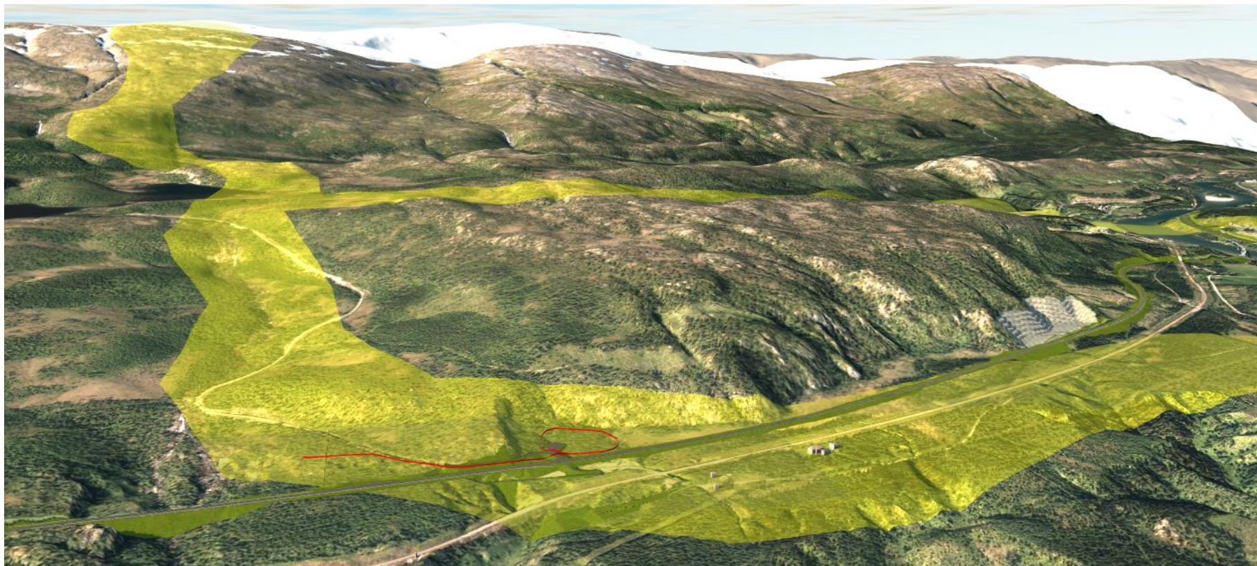
3D-modell over ny E6 i Grane kommune. Flyttlei fra reindriftskart er lagt inn i modellen.
