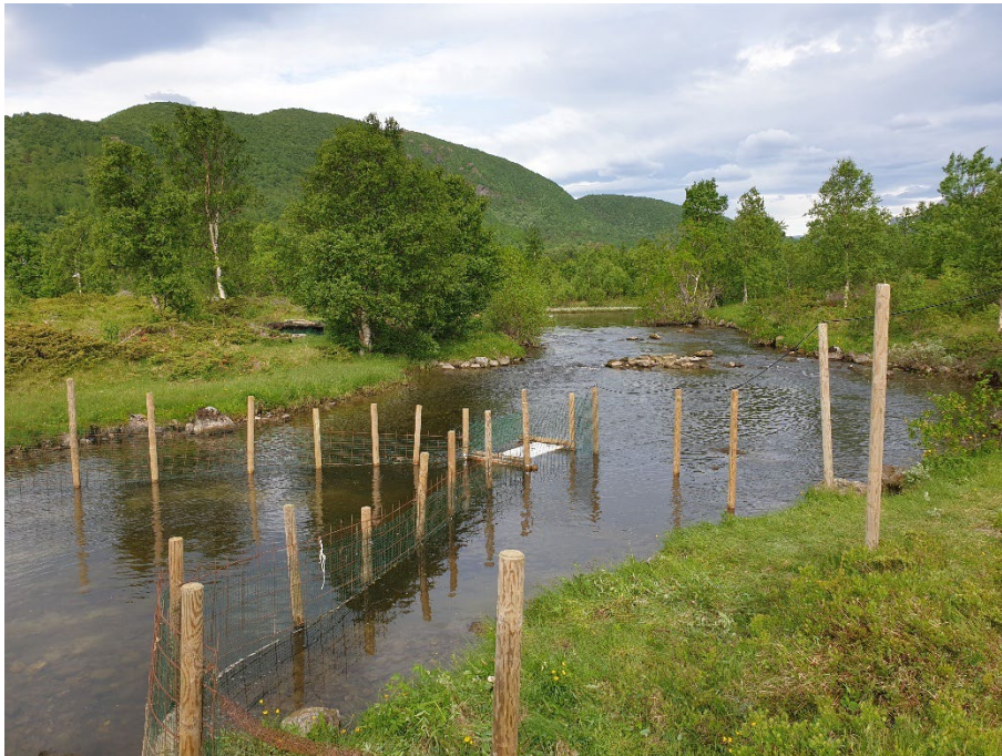
Bilde: Ledegjerde og videotunnel i Fjæreelva 2024.
