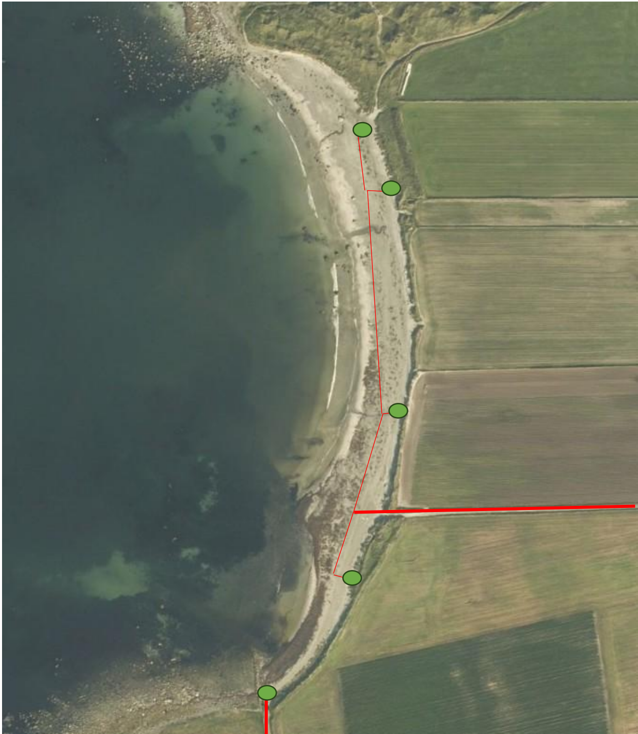
Figur 4: Godkjente kjøretraséer i forbindelse med vedlikehold av dreneringsgrøfter – og rør. Uthevet rød strek indikerer godkjent trasé for tilkomst til strand, rød strek indikerer kjøretraséer på strandflaten og grønne sirkler markerer grøftene. Alle markeringer er omtrentlige, men følger prinsipp om kjøring på strandflate, for å unngå videre erosjon av sanddynene.
