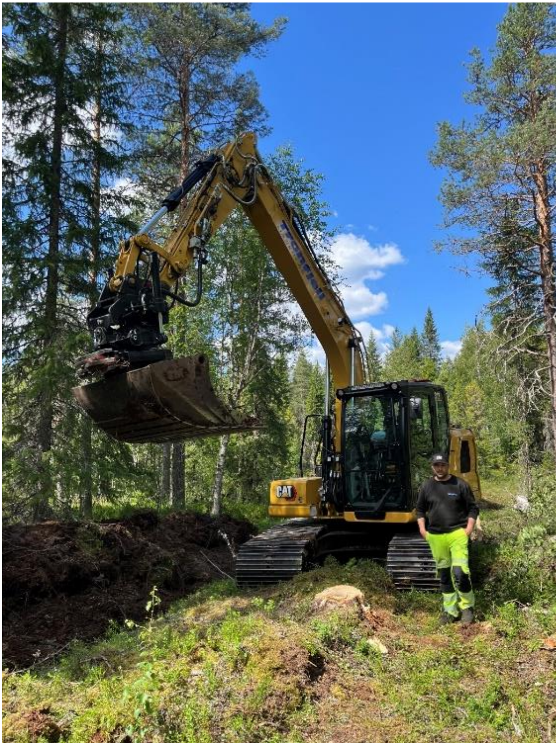
Figur 50: Gravemaskin med tiltrotator montert. Denne er også utstyrt med gripekassett til å håndtere trær med. Foto: Kjølsv. Falklev
