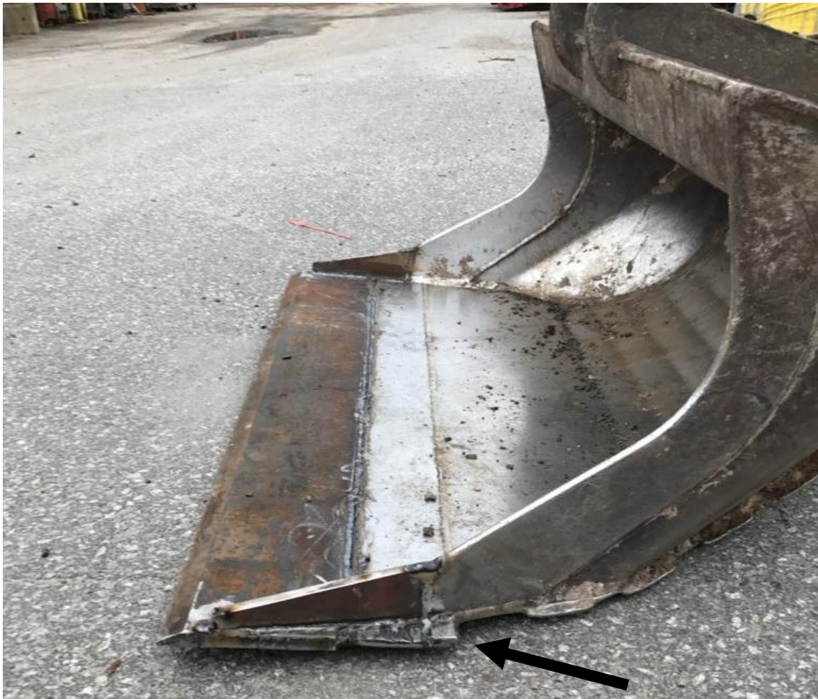
Figur 49: Pusseskuffe som er forlenget, og satt på kant på sidene. Foto: Per Morten Hauge
