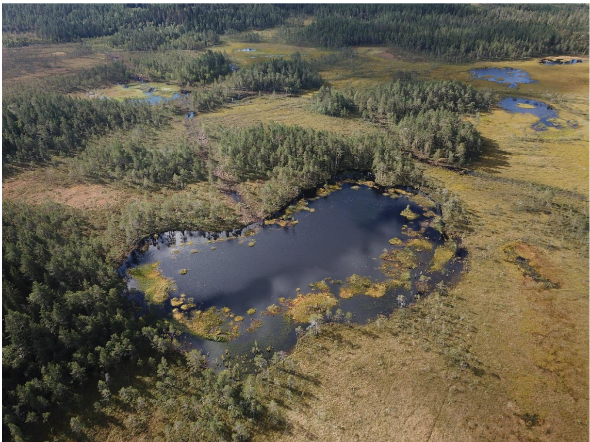
Figur 46: Hevet tjern i Brenninga naturreservat. Det naturlige utløpet er øverst til høyre i tjernet. Grøfta går ut øverst på midten. Her er det laget en forsterket demning som er høy nok til at vannet nå renner ut ved det naturlige utløpet. Foto: Kjølsv. Falklev
