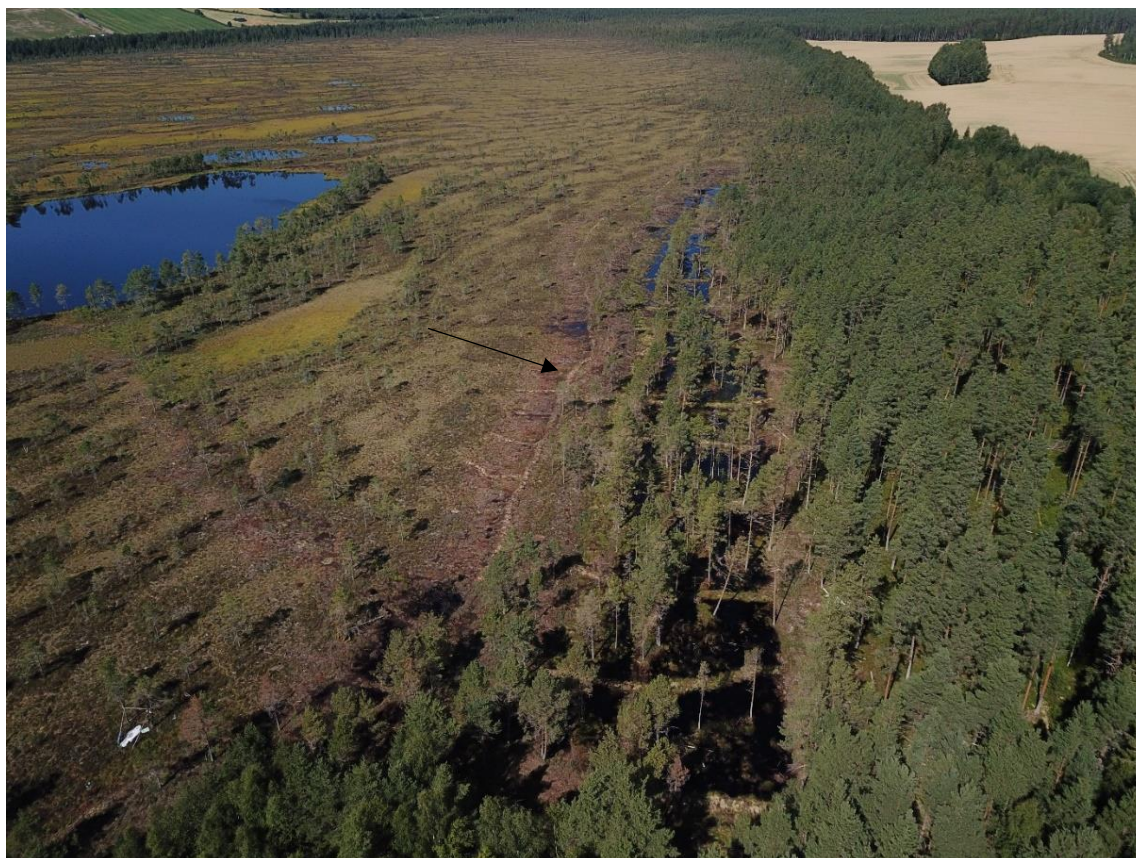
Figur 34: Til venstre i bildet sees en lang kantdemning med en finger for hver 15. meter. Brytningsdemningen ligger på kanten mot en reprofilert kant som ender ned i et restaurert torvuttak. Rønnåmyra naturreservat 10. august 2020 Foto: Kjølsv. Ø. Falklev
