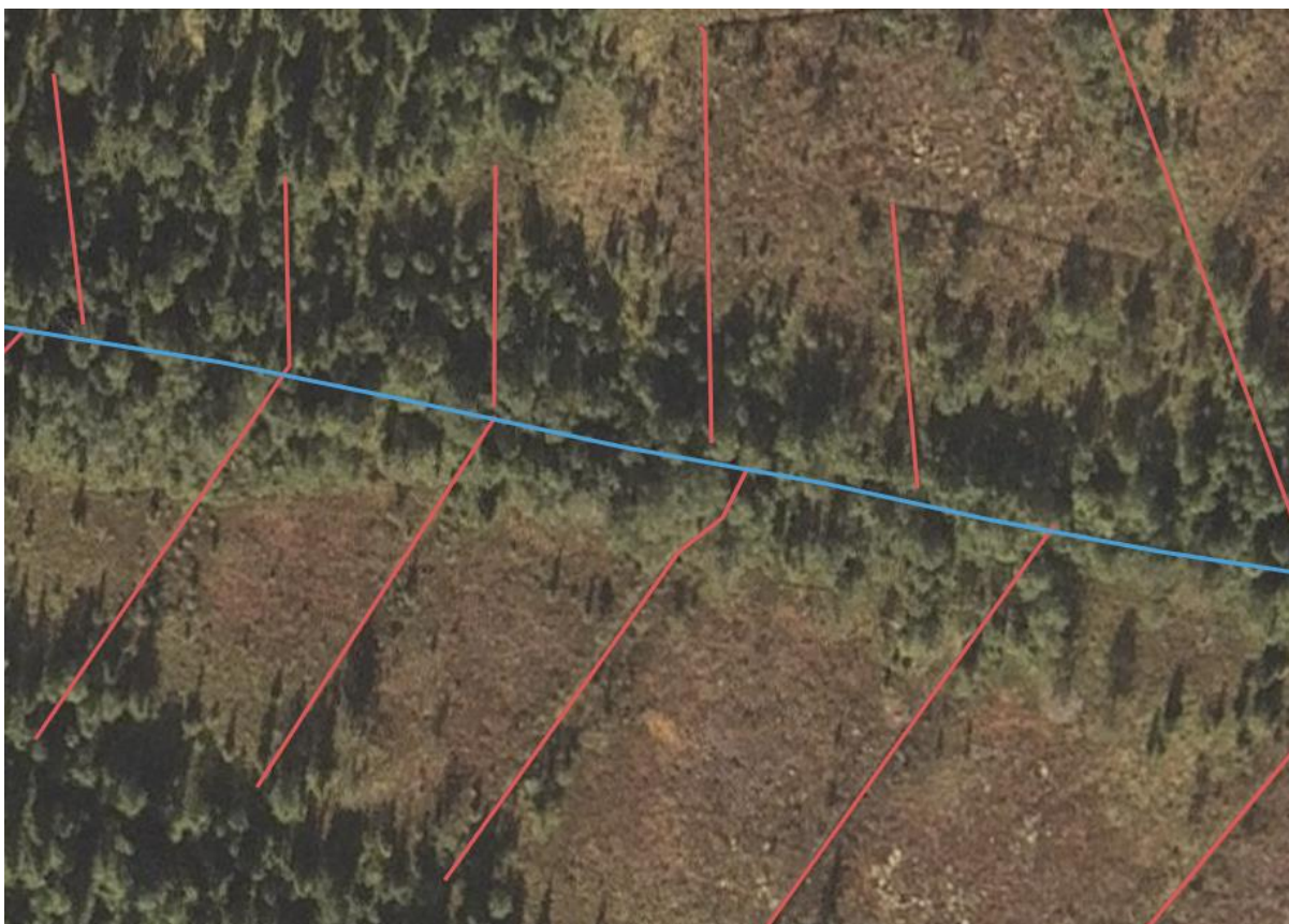
Figur 9: Viser grøfter (røde linjer) som er gravd helt ut til et vassdrag (blått), og hvordan trærne i kantsona mot vassdraget vil måtte tas ned om vi skal tette grøftene. Foto: Kartverket.
