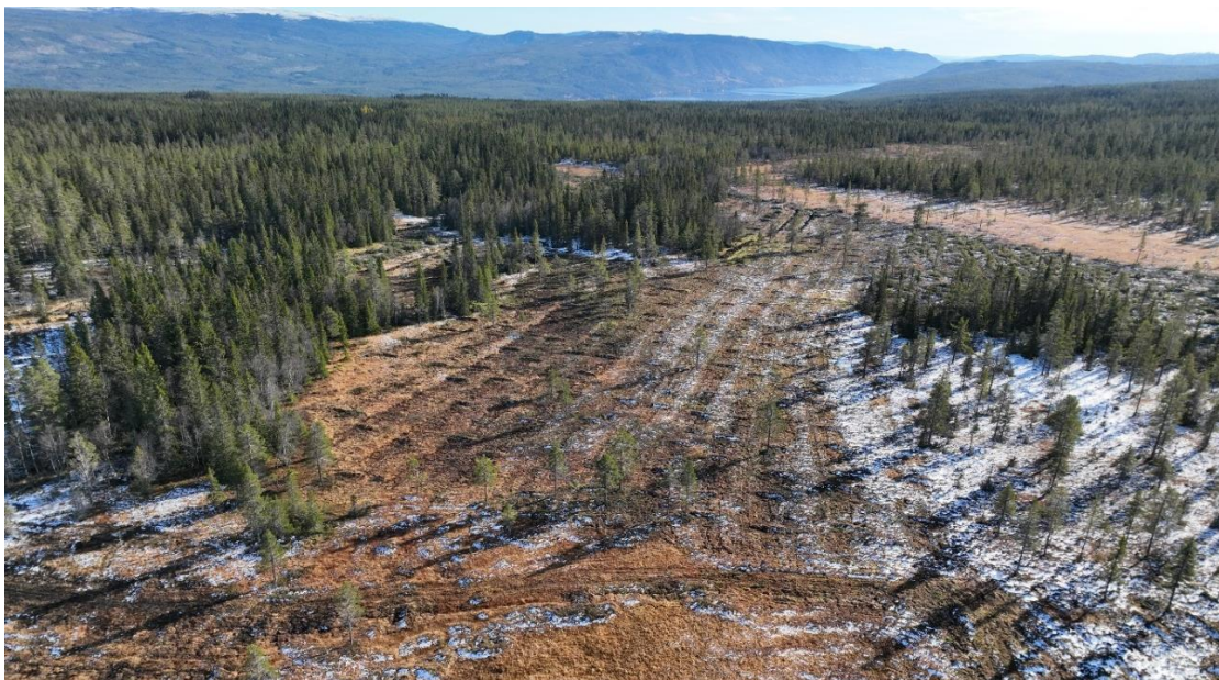
Figur 24: Restaurert myrflate med mange plugger. Helningen går på skrått fra høyre mot venstre. Pluggene stopper vannet og sender det i samme retning som helningen. Lange demninger her ville være unødvendig bruk av torvmasser, arbeid uten noen funksjon. Vollmyra i Rendalen kommune 15.oktober 2024. Foto: Kjølvs Ø. Falklev
